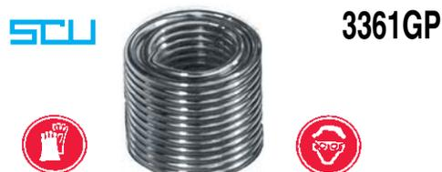
Filo saldante di stagno allo stato puro 99,3% con disossidante interno PAT-DE 19816671C2. Per saldature, senza la presenza di piombo, di materiali in campo elettrico, elettrotecnico, elettromeccanico ed elettronico. Temperatura di fusione 217 °C - 227 °C.
